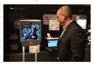
Le robot UBY est équipé de deux caméras (une dirigée vers le sol et une autre au-dessus de l'écran) permettant à la fois aux utilisateurs de guider le robot et de visionner l'exposition commentée par le conférencier. L'échange étant permanent avec l'image et le son, les flux audio et vidéo sont retransmis et diffusés en direct aux élèves installés dans leur salle de classe. Avec ce direct, les élèves ont la possibilité d'échanger et de poser des questions au guide.
